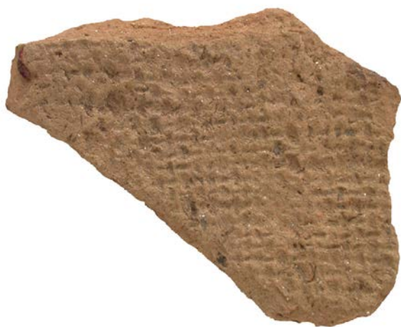
Abb. 17: Textilabdrücke auf der Rückseite eines geborgenen Kachelfragments aus dem Nebengebäude von Schloss Hanfelden (Foto: R. Fürhacker 2018)
